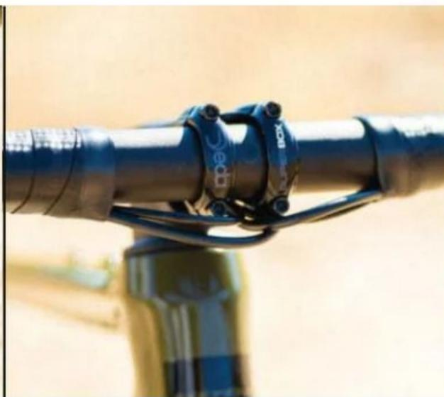
**SEMIOCULTO.** Los cables y fundas de los cambios, y los latiguillos de frenos, van guiados por el interior del cuadro y la horquilla. Sólo asoman unos centímetros por debajo de la potencia y el manillar, facilitando la sustitución de estos dos componentes.
